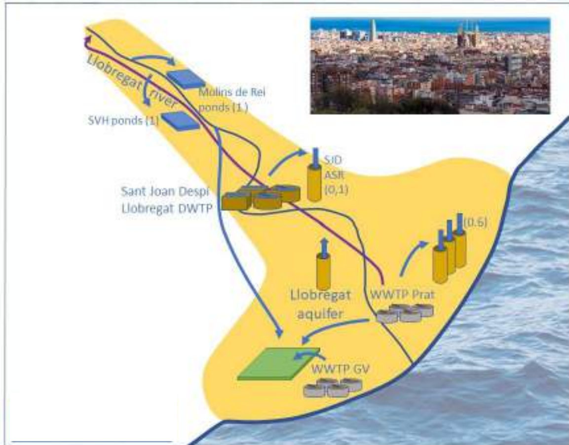
Figura 7. Esquema del ciclo hídrico del acuífero del Valle Bajo y Delta del Llobregat dentro de la zona de estudio
