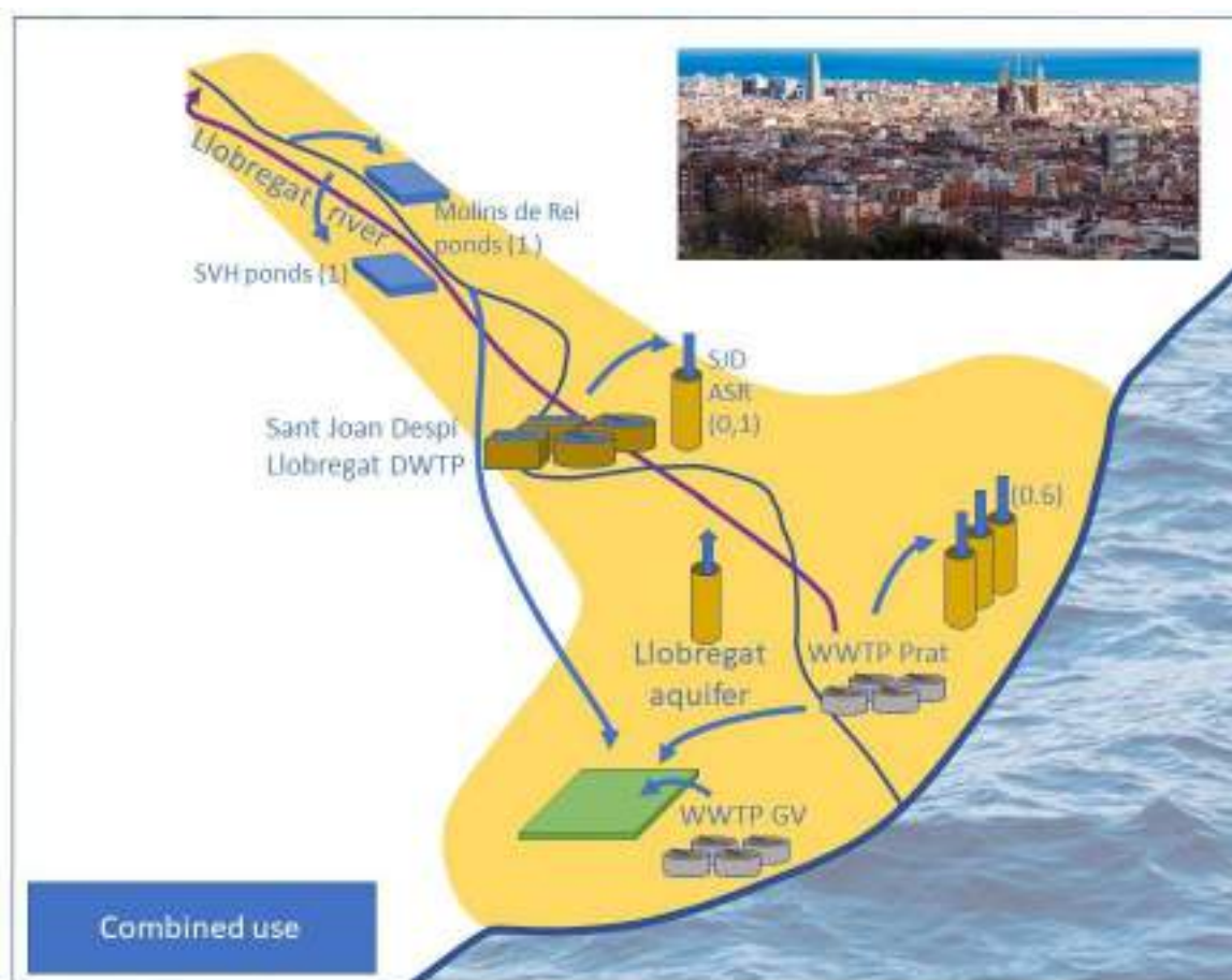
Figure 12. Diagramme de l'utilisation intégrée des différentes sources d'eau présentes dans la zone d'étude.
