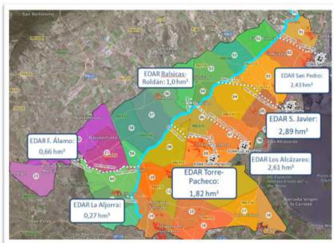
Figure 5. Raccordement de l'eau recyclée au canal de distribution et volume annuel d'eau recyclée dans chacune des STEP de la zone d'étude. Préparé par CRCC.
