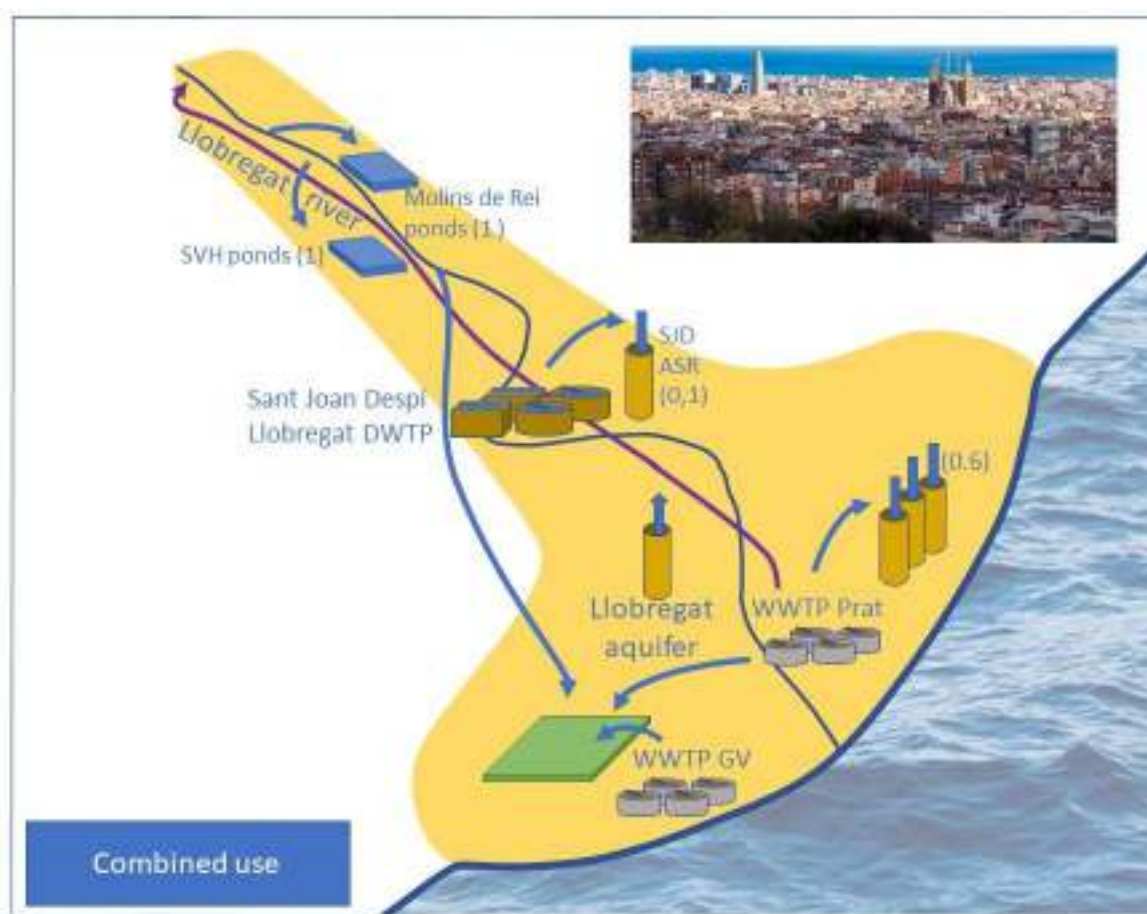
Figura 12. Esquema del uso integrado de los diferentes orígenes de agua presentes en el ámbito de estudio
