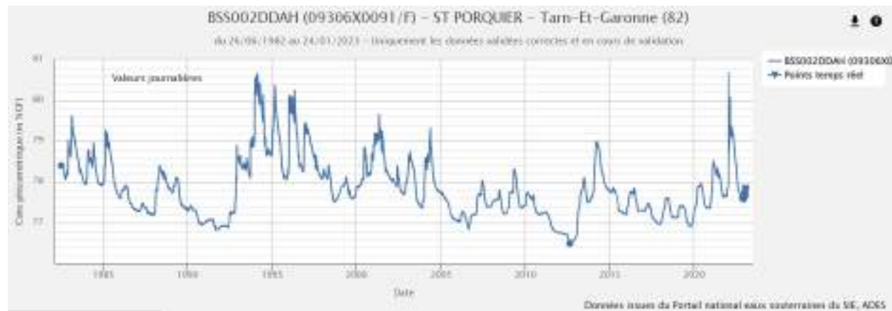
Côte piézométrique enregistrée sur le point BSS002DDAH – St-Porquier (Source : Point d'eau 09306X0091/F - Site public - ADES (eaufrance.fr) )
