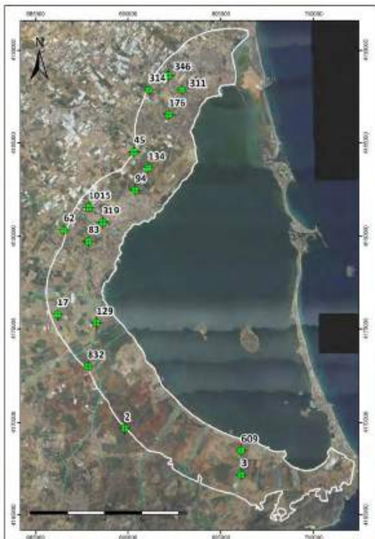
Figura 2-5: Valores de transmisividad obtenidos en los ensayos de bombeo (CHS-Tragsatec, 2020).
