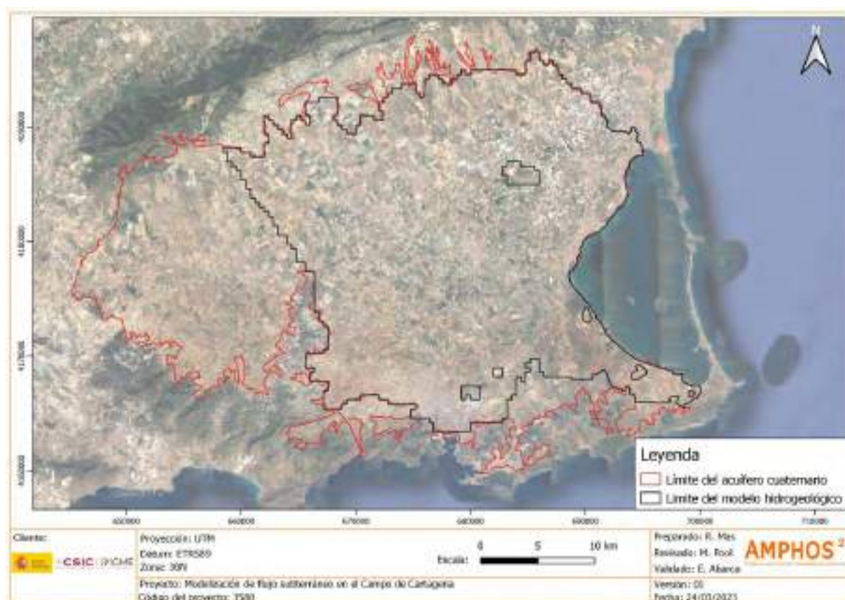
Figura 4-2: Dominio de modelación (línea negra) y límite de los afloramientos cuaternarios (línea roja) en la cuenca del Campo de Cartagena.
