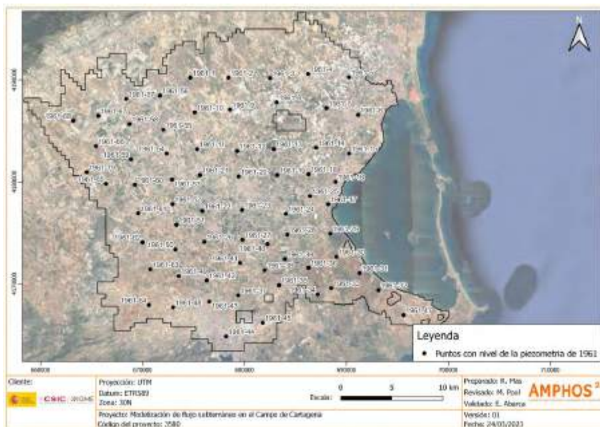
Figura 4-18: Puntos de observación virtuales incluidos en el modelo numérico con medida de nivel a partir de la piezometría del año 1961.
