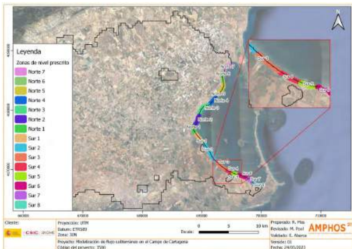
Figura 4-9: Celdas definidas y segmentos con condición de contorno de nivel prescrito para representar la conexión entre el acuífero y la laguna.
