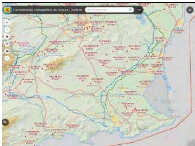
Figura 18. Visor de CHS con la representación de los puntos de la red piezométrica.
